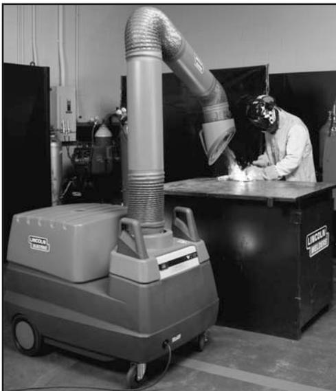
Unidad móvil de extracción de humo de bajo vacío Mobiflex™ 200-M.
