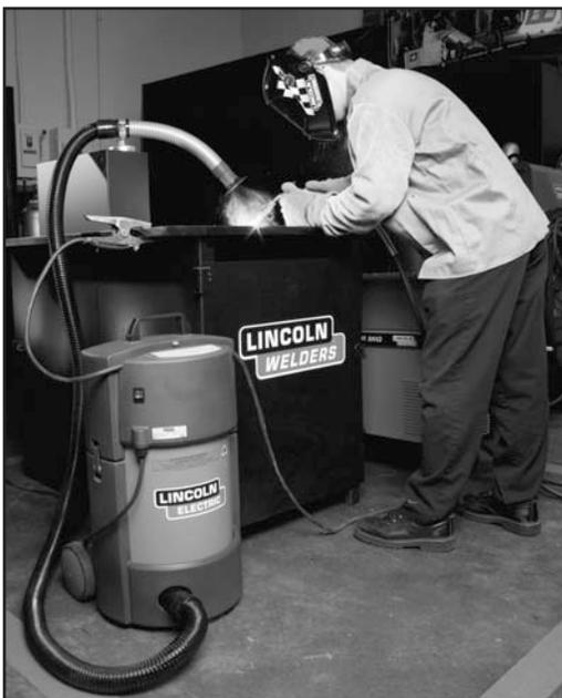
Unidad de extracción de humo portátil de alto vacío Miniflex™.
